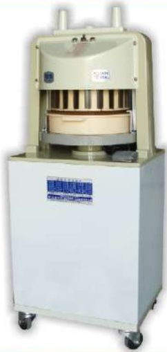
USK-83 電動麵團分割機 尺寸：51x41x131cm 馬力：1/4HP 重量：120kg 備註：可分割35-100g(36塊) 110-220g(18塊)
