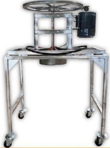
USK-09S 白鐵米苔目機 尺寸：102x69x142cm 馬力：1HP 桶子尺寸：Ø30x15cm 規格：Ø4或5mm
