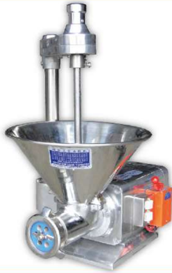
USK-164 電動切圓機 尺寸：58x43x70cm 馬力：1HP 重量：40kg 用途：快速切湯圓、芋圓、地瓜圓(圓柱型) 備註：無法長短大小一致
